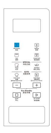
使用不同的微波火力進行烹調,可反覆按下微波掣 選擇一個烹飪火力, 然後按 +/-掣, 以設置一個理 想的烹調時間。烹調時間最長為90分鐘。
