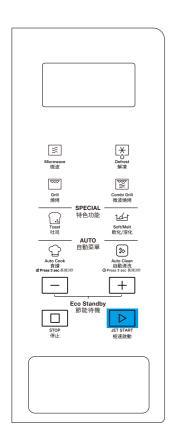
此功能允許您快速啟動微波爐。按下極速啟動 掣一次, 微波爐自動開始工作(全火力狀態)。 烹飪過程中,可按極速啟動掣增加時間。烹調時 間最長為90分鐘。
