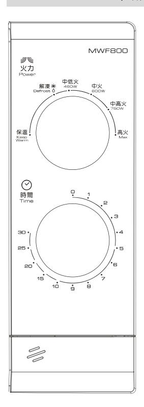
此控制面板由兩個功能操作旋鈕組成,一個是烹調時間旋鈕,另一個是火力控制旋鈕。
