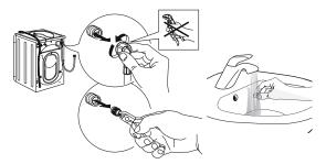
**4.** 裝回濾網並將進水喉擰回機上。不要使用其他工具來連接進水喉。打開水龍頭並確認各連接位均完全不漏水。
